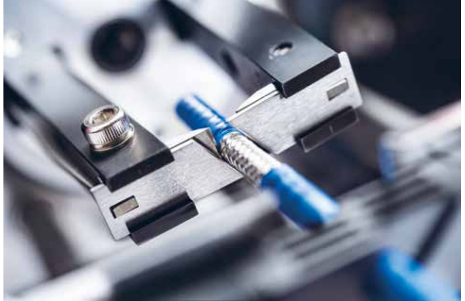
Rotationsschnitt, Zentrierung und Flachmesser für einen äusserst glatten Schnitt.
