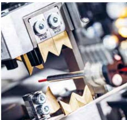
Mit dem Doppelmesserhalter können zwei verschiedene Messerradien oder Spezialmesser auf Knopfdruck ausgewählt werden.
